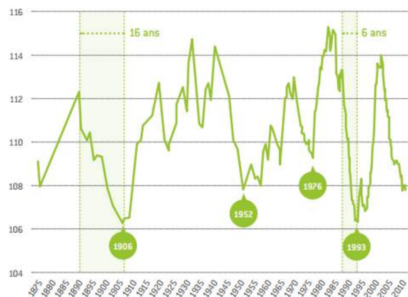
Figure 60 : Variation du niveau de la nappe de Beauce à la sucrerie de Toury de 1875 à 2012 (Source : SAGE Nappe de Beauce)
